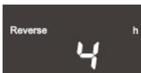
O tempo de polaridade reversa pode ser definido para 2h/4h/6h/8h e o padrão de fábrica é 4h. A função de autolimpeza pode efetivamente eliminar os acessórios acumulados no eletrodo e manter o eletrodo em boas condições de funcionamento.
